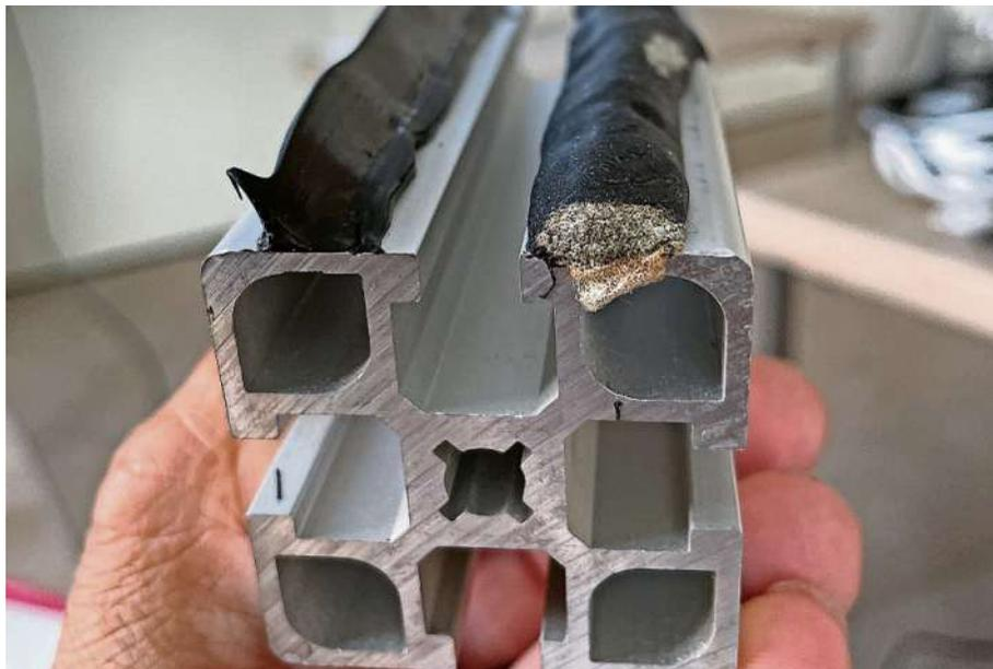
Kleber ist nicht gleich Kleber. Gerade bei der starren oder einer elastischen Verklebung gibt es große Unterschiede. Foto: energiekonsens
