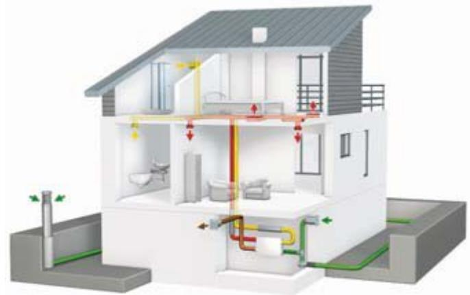
**Die kontrollierte Wohnraumlüftung wird verstärkt in Neubauten eingesetzt.**
